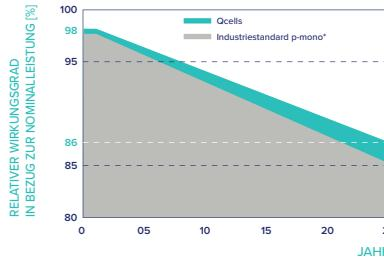
Mindestens 98% der Nennleistung innerhalb des ersten Jahres. Danach max. 0,5% Degradation pro Jahr. Mindestens 93,5% der Nennleistung nach 10 Jahren. Mindestens 86% der Nennleistung nach 25 Jahren.
